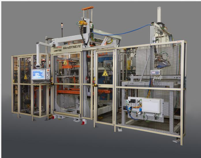
AkroDYNE<sup>®</sup> FX 乘用车及轻卡车轮胎动平衡试验机
